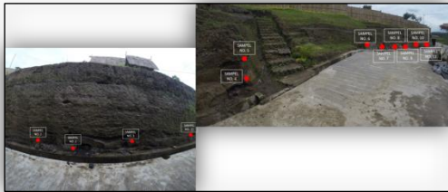
Gambar 4. Foto singkapan pengambilan sampel sebanyak 19 sampel terpilih yang diambil secara lateral searah dengan lapisan, secara keseluruhan semua sampel terdiri dari batulempung kaya akan material organik dengan sisipan abu gunung api, kecuali sampel No. 5 terdiri dari konglomerat dan pasir.
